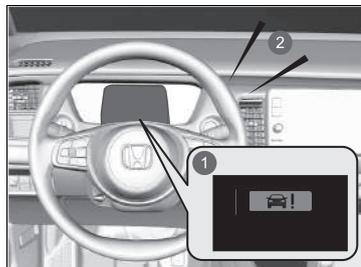
Le système émet des alertes visuelles et sonores en cas de risque de collision et s'arrête si la collision est évitée.
