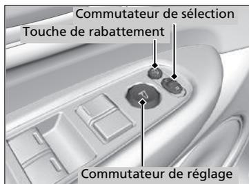
Il est possible de régler les rétroviseurs extérieurs lorsque le contacteur d'allumage est sur MARCHE **II**\*1.
