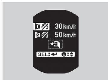
1. Appuyer sur le bouton / jusqu'à ce que l'écran de réglage de l'alarme de vitesse apparaisse sur l'écran, puis appuyer sur le bouton **SEL/RESET**.
