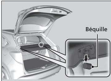
3. Désengager les tiges de support, puis déposer le cache du compartiment à bagages.
