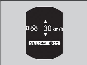
1. Appuyer sur le bouton ▲①/▼ jusqu'à ce que le menu de réglage de l'alarme de vitesse apparaisse sur l'écran, puis appuyer sur le bouton **SEL/RESET**.
