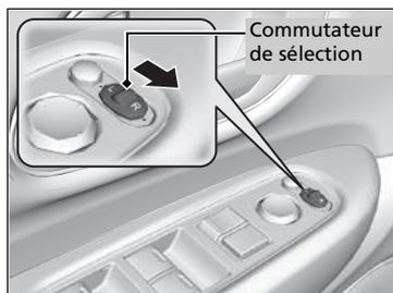
S'il est activé, le rétroviseur côté passager s'incline automatiquement vers le bas lorsque la transmission est en position **R** ; ceci améliore la visibilité côté passager du véhicule lors d'une marche arrière. Le rétroviseur revient automatiquement sur sa position d'origine lorsque la transmission est désengagée de la position **R**.
