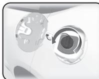
**3** Placer le bouchon dans le support situé dans la trappe à carburant.
