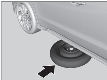
**7.** Placer la roue de secours (côté voile de jante dirigé vers le haut) sous la caisse du véhicule, près de la roue devant être remplacée.
