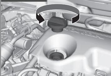
1. Dévisser et retirer le bouchon de remplissage d'huile moteur.
