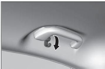
Des crochets porte-manteau sont montés sur les poignées de maintien arrière gauche et droite. Les faire sortir en les tirant vers le bas pour les utiliser.
