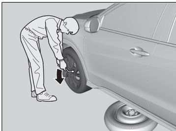
**8.** Desserrer chaque boulon de roue d'un tour environ à l'aide de la clé de boulon de roue.
